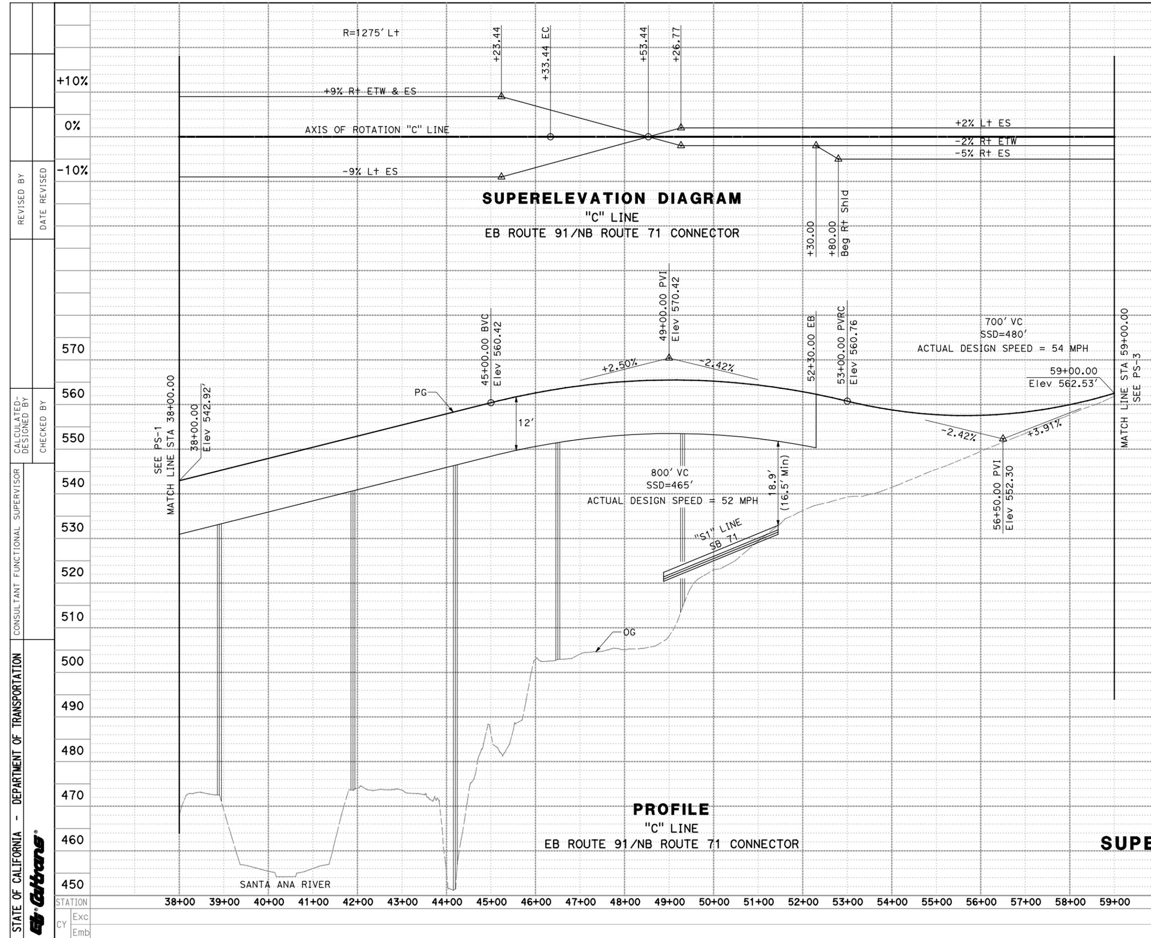
**PROFILE AND SUPERELEVATION DIAGRAM**
