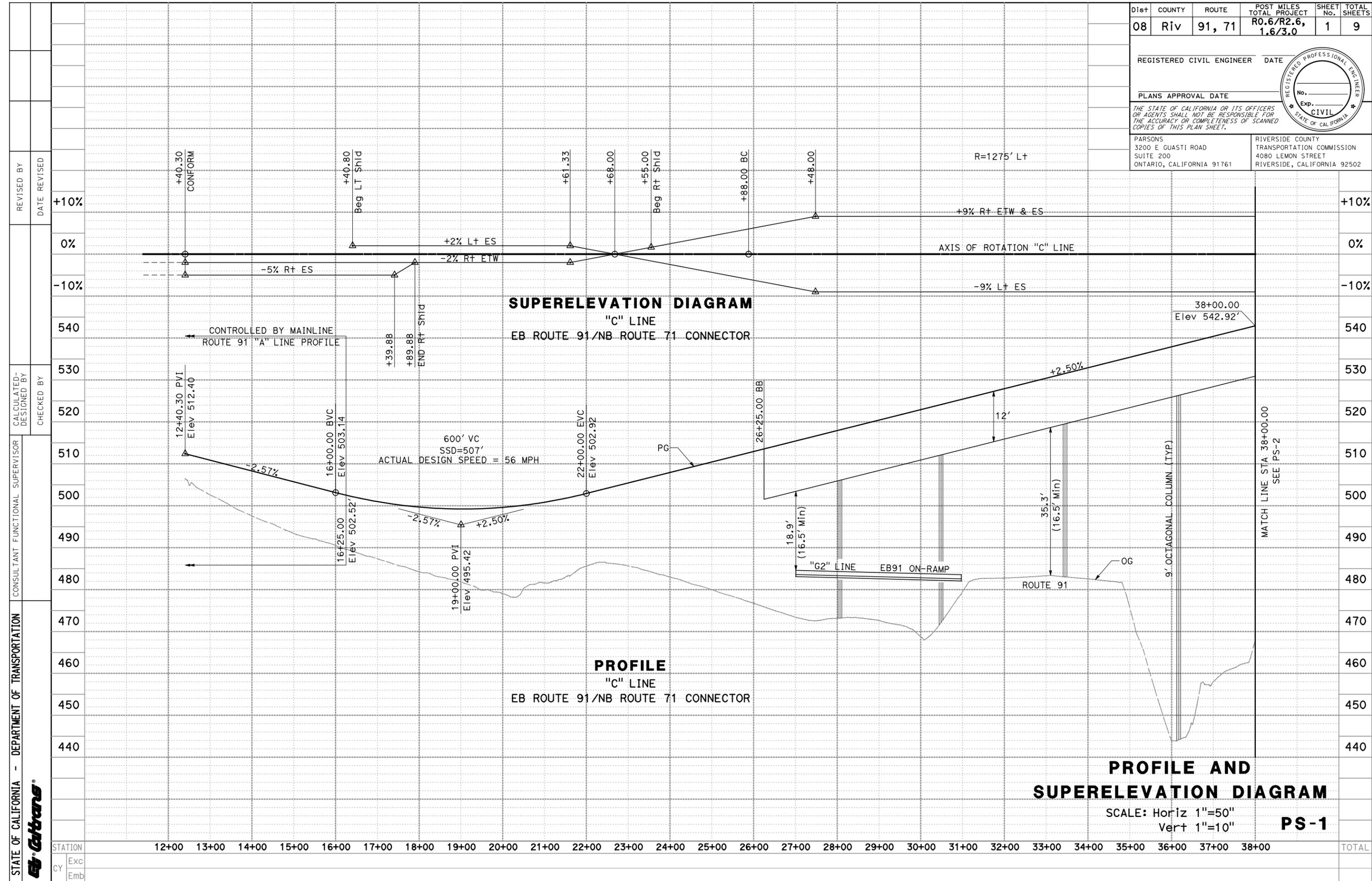
**PROFILE AND SUPERELEVATION DIAGRAM**
